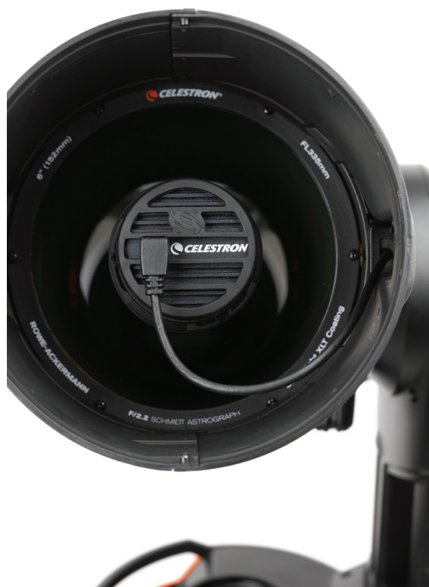
ABB. 29: Der im Werk aufgenommene und auf Origin vorgeladene Flat-Frame wurde mit der Kamera in der gezeigten Ausrichtung aufgenommen. Wenn Sie die Kamera aus dieser Ausrichtung herausdrehen, müssen Sie einen neuen Flat-Frame erstellen.
