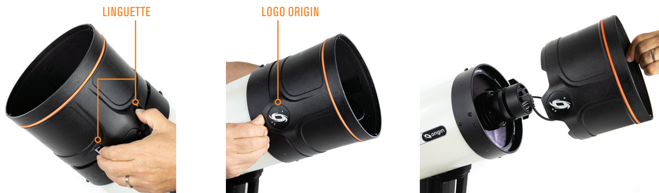
Fig. 13: Rimuovi il paraluce premendo le due linguette con una mano mentre spingi verso l'alto sotto il logo Origin.
