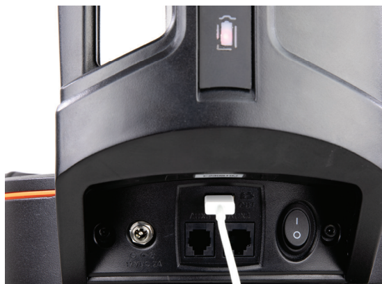
Fig 38 Vous pouvez utiliser le port de chargement USB du support Origin pour charger votre appareil sur le terrain.
