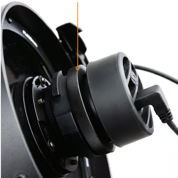
FIG 30: Si desea rotar la orientación de la cámara, afloje primero la arandela de bloqueo de cámara.
