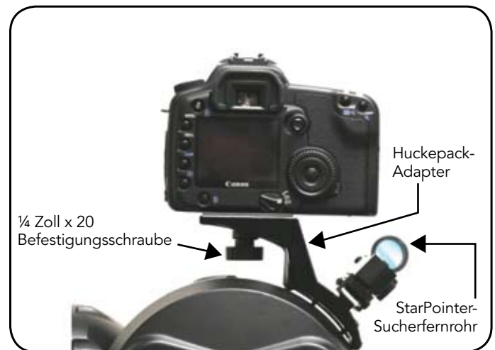
ABB. 2 – MIT AUFGESETZTEM HUCKEPACK-ADAPTER, STARPOINTER UND KAMERA
