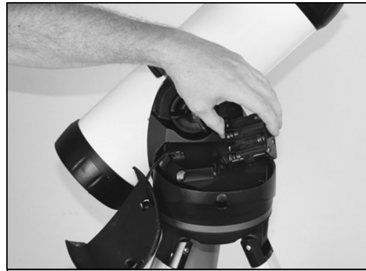
Figura 2-11b – Cómo colocar las pilas
