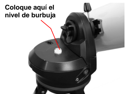
Figura 2-5 – Nivelación de la base
