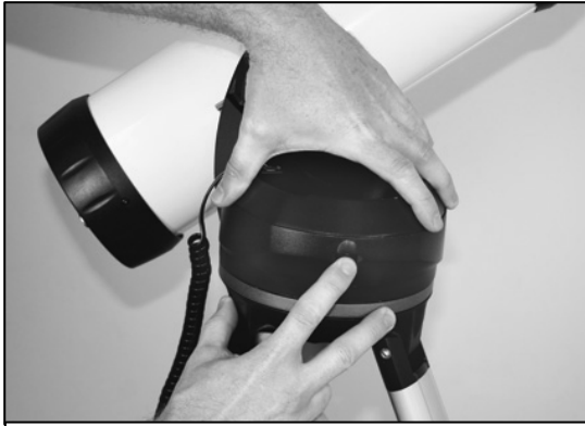
Figura 2-11a – Cómo quitar la tapa del compartimiento de pilas
